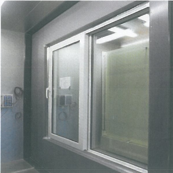
<사진 1> 열관류율 항온측 시험체 모습
