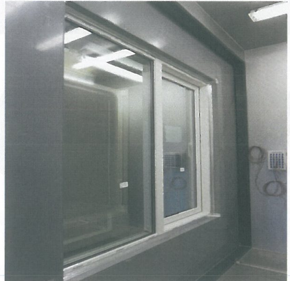
<사진 2> 열관류율 저온측 시험체 모습
